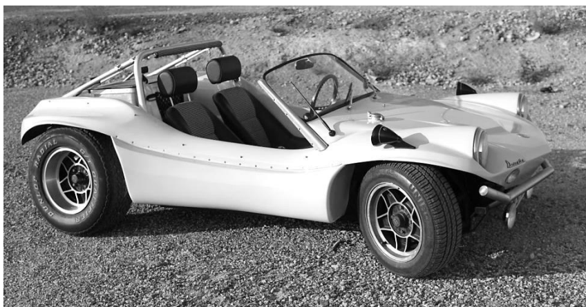
Deserter GT - Buggy mit ATS Classic-Radsatz 7x15 vorne / 9x15 hinten
