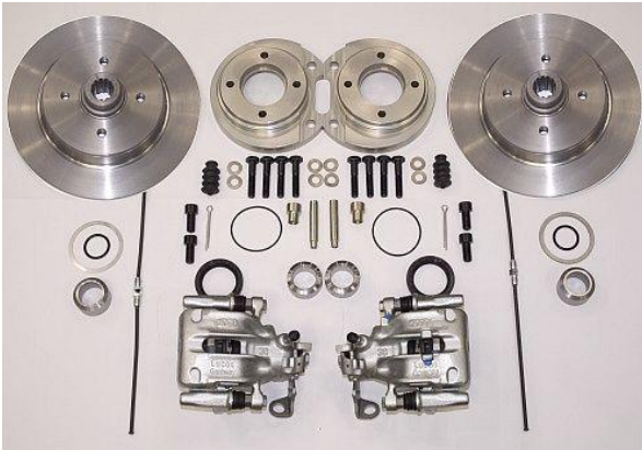
Umbausatz auf Scheibenbremsanlage hinten
