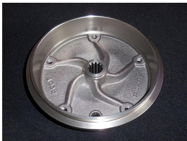
Bremstrommel hi. mit LK 5x205 (Innenseite)
