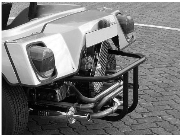
Motorschutzbügel „Spezial“ z.B. am Apal-Buggy
