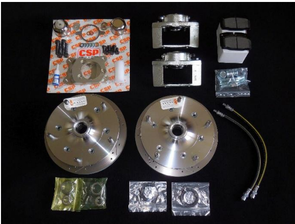
Scheibenbremsanlage vorn mit LK 5x205
