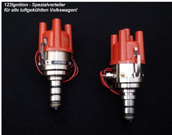
wahlweise mit oder ohne Unterdruckanschluß
