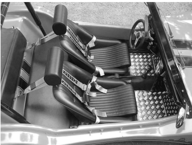
Einbaubeispiel: Modell „Nürburgring“ im VW Buggy
