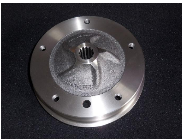
Bremstrommel hi. mit LK 5x205 (Außenseite)
