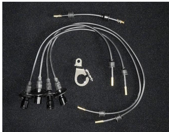
neuer Zündkabelsatz und neue Verteilerklemme
