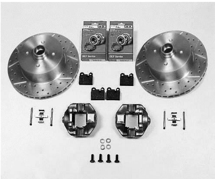
innenbel. Scheibenbremsanlage vorn, gelocht/geschlitzt
